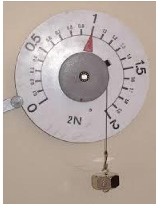
Le dynamomètre indique que l'intensité du poids est  $p=1\text{N}$
